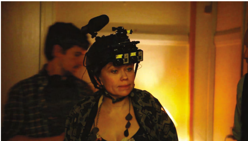
Figure 5 : Une paire de caméras de marque GoPro modifiées pour capter un champ de vision élargi. Pendant le tournage, les caméras étaient portées en alternance par chacun des cinq acteurs.
