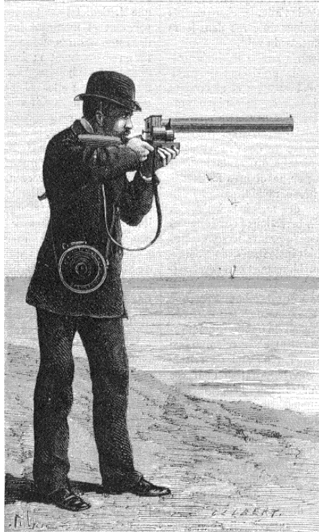
Fig. 1 Handling of Marey’s fusil photographique .
